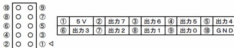
図 3 接続ケーブル B のピン配置図
